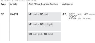
700mA - 9,4Vdc ~671 lm\* ~102 lm/W\*
